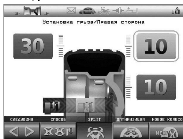
Рисунок 7.5 – Экран установки грузов в режиме Split
