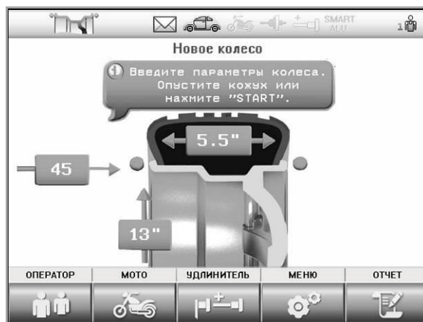
Рисунок 4.8 – Состояние «Новое колесо»
