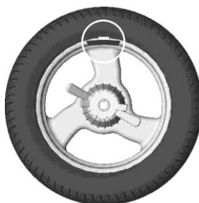
Рисунок 6.3 – Груз установлен в положение «12 часов»
