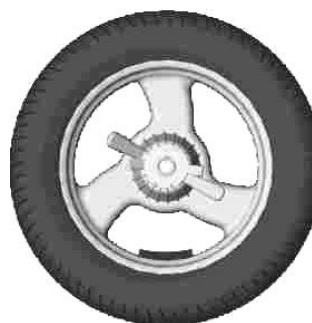
Рисунок 6.11 – Установка ленточных грузов
