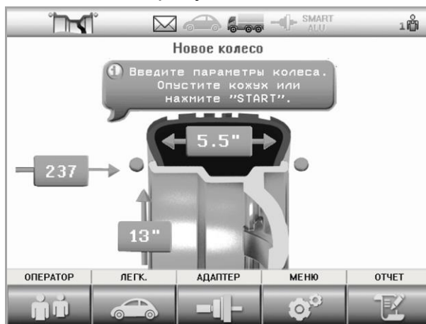
Рисунок 4.11 – Состояние «Новое колесо»
